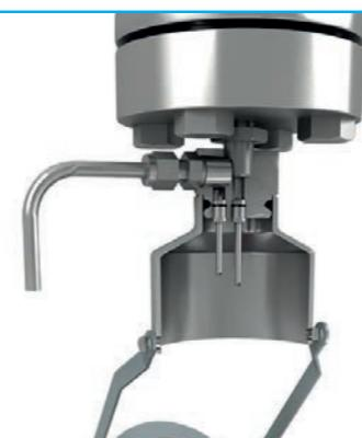
Al extraer el recipiente con la muestra, el septum, sella inmediatamente los orificios de penetración de las agujas. A continuación se procede a llevar el recipiente al laboratorio, pudiendo extraer el líquido mediante una jeringa, minimizando la exposición del personal.
